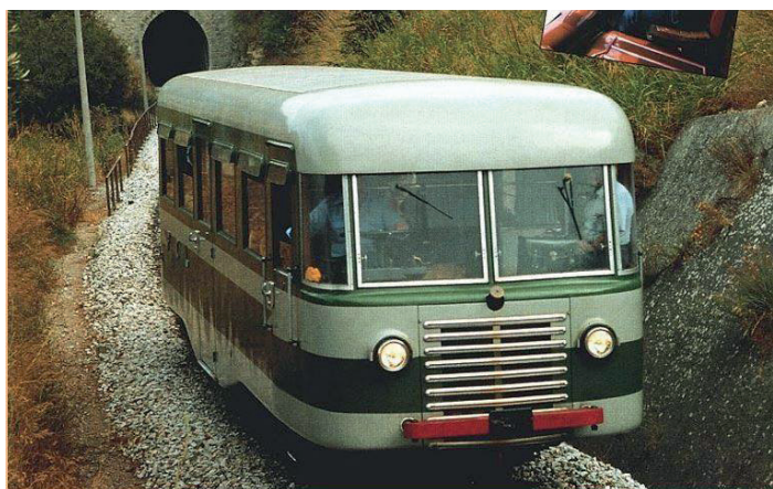
Automotrice M1C80 INOX con cassa inossidabile e propulsore OM, costruite dalla Piaggio nel 1936-37.jpg
